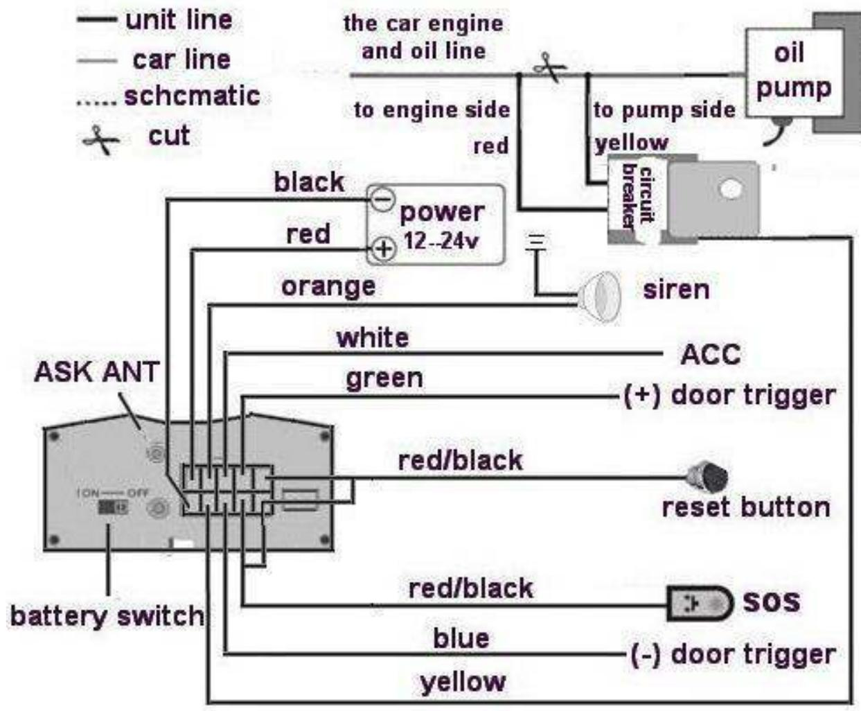
**6.1.5** Nota: Il filo arancione può essere collegato alla dispositivo di allarme originale della vettura, ma può anche essere collegato alla sirena fornita con il tracker. (opzionale)
